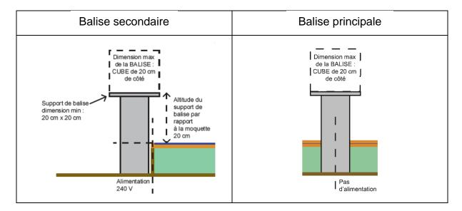
L'emplacement imposé pour les balises principales et les emplacements possibles pour les balises secondaires vous sont indiqués sur la figure suivante :
